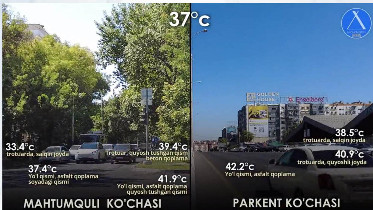
1-rasm. Daraxtlarni havo haroratiga ta'sirini aniqlash bo'yicha Toshkent shahridagi Parkent va Mahtumquli ko'chalarida o'tkazilgan tajriba natijalari [10].
