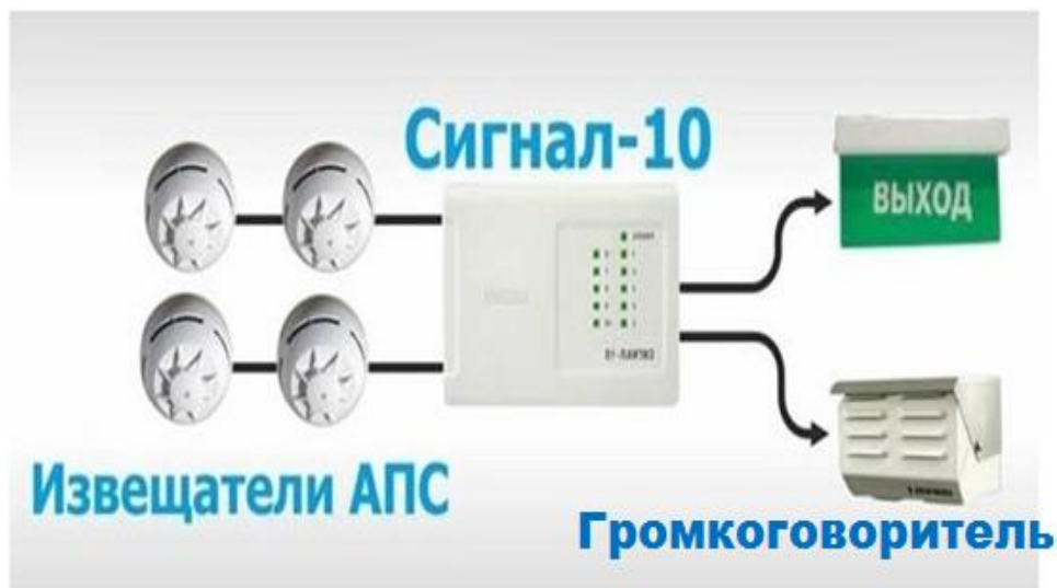
Рисунок-2. Схема автоматической пожарной системы
