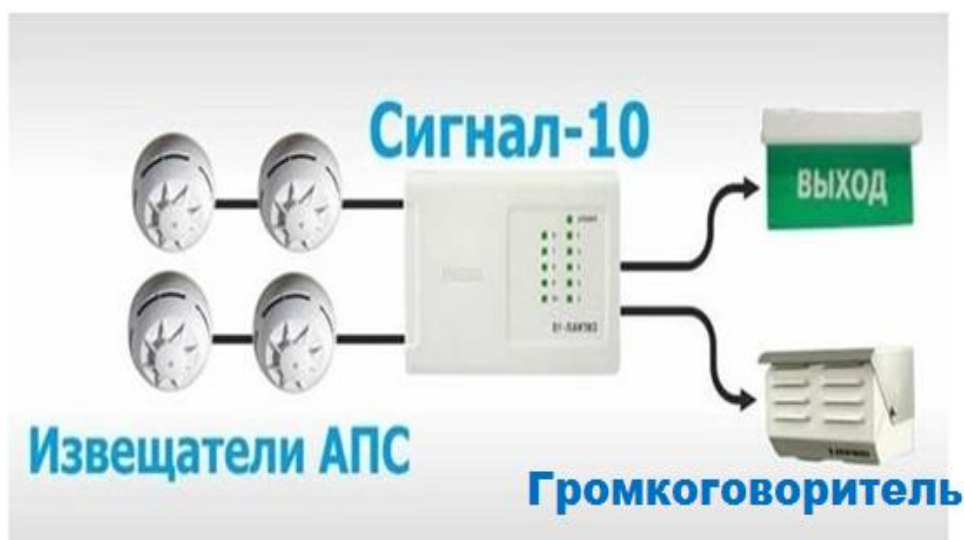
Рисунок-2. Схема автоматической пожарной системы
